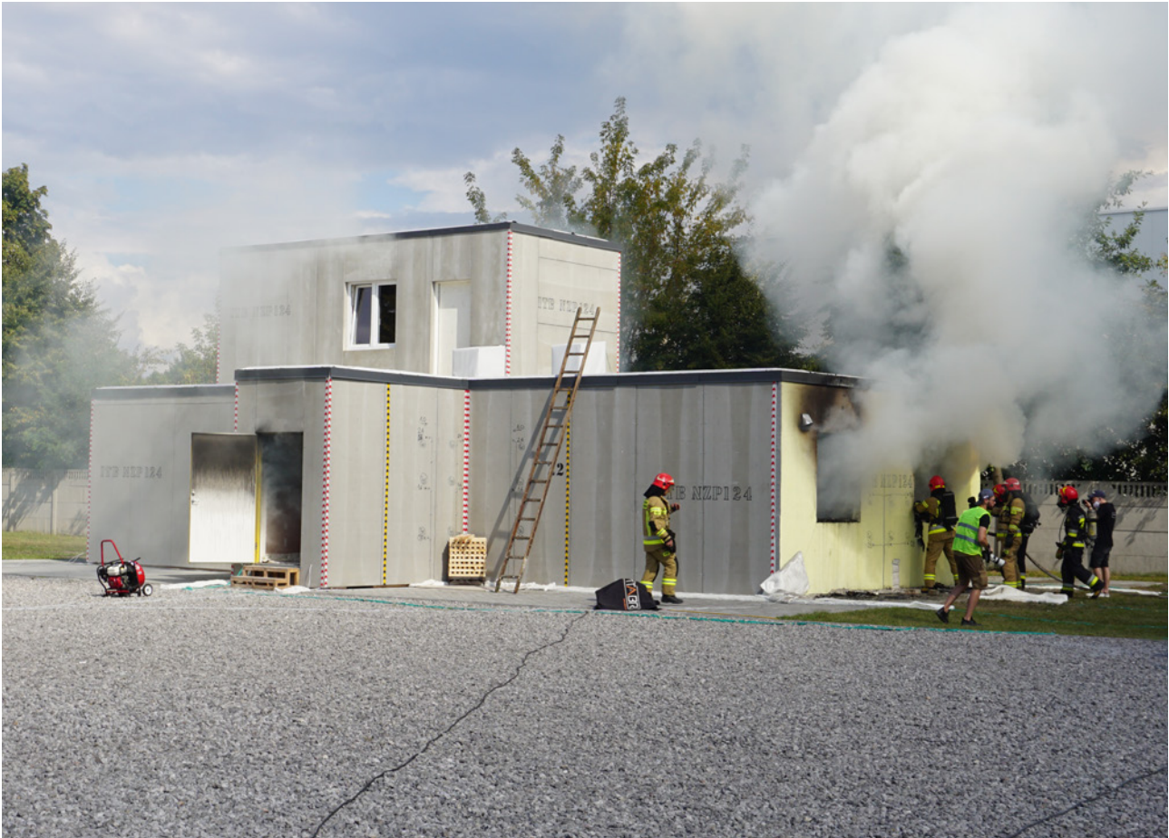
Eksperyment pożarowy w skali rzeczywistej budynku wielokondygnacyjnego
