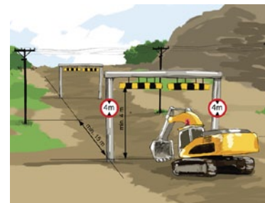
Rys. 4. Prace w bezpośrednim sąsiedztwie napowietrznych linii energetycznych
