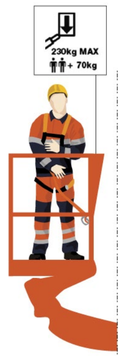
Rys. 2. Informacja o dopuszczalnym obciążeniu platformy podestu ruchomego
