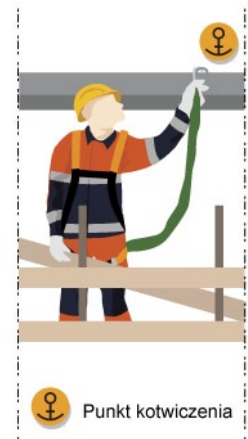
Rys. 2. Punkty kotwiczenia indywidualnych środków chroniących przed upadkiem z wysokości
