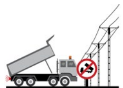
Rys. 5. Zakaz podnoszenia skrzyń ładunkowych w sąsiedztwie napowietrznych linii energetycznych
