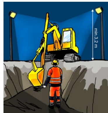
Rys. 5. Oświetlenie placu budowy
