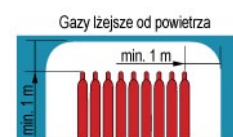
Rys. 11. Wymiary stref ochronnych dla butli z gazami palnymi podczas przechowywania na wolnym powietrzu
