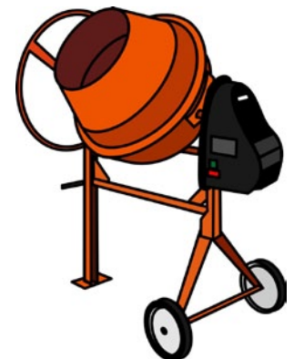
Rys. 6. Osłona elementów napędowych
